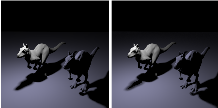
FIGUUR 4.2: Deterministische evaluatie voor de Killeroos scene. De linker afbeelding is gerenderd met deterministische visibiliteit. De rechter afbeelding is gerenderd met het occlusion mapping algoritme door deterministisch al de blokkers gevonden in de occlusion map te testen.
